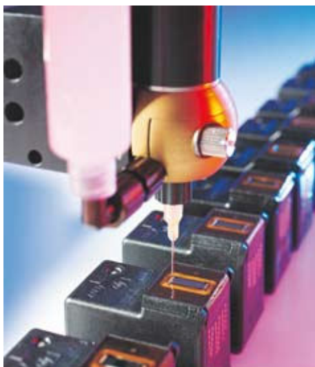
• Dosatura di fluidi sedimentabili e paste di saldatura TS5000DMP, TS500R , serbatoio
