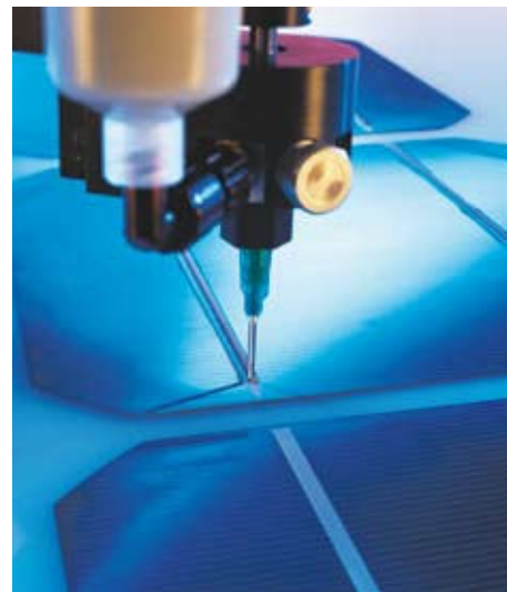
• Dosatura di pasta per saldatura TS7000, TS550R
