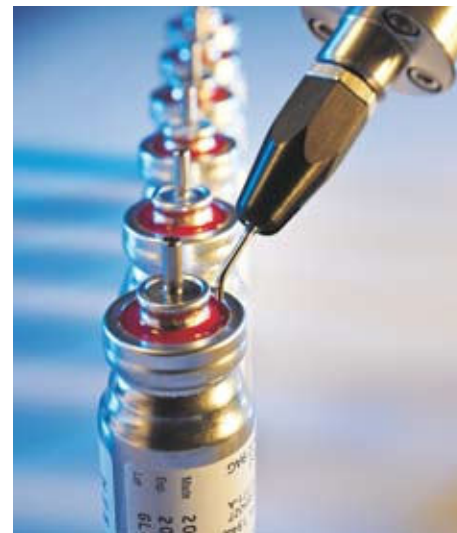
• Dosatura di resine TS5440, TS500R , serbatoio
