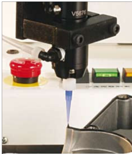
• Formazione di guarnizioni "in luogo" TS350, TS5322 , pompa
