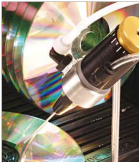
• Applicazione di coating TS5622VU -DVD, TS500R , serbatoio
